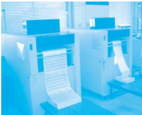
② カメラで組合員コードを読み取り、注文書とお届け表などの組合員コードが違った場合には、すぐに機械が止まるようになっています。
